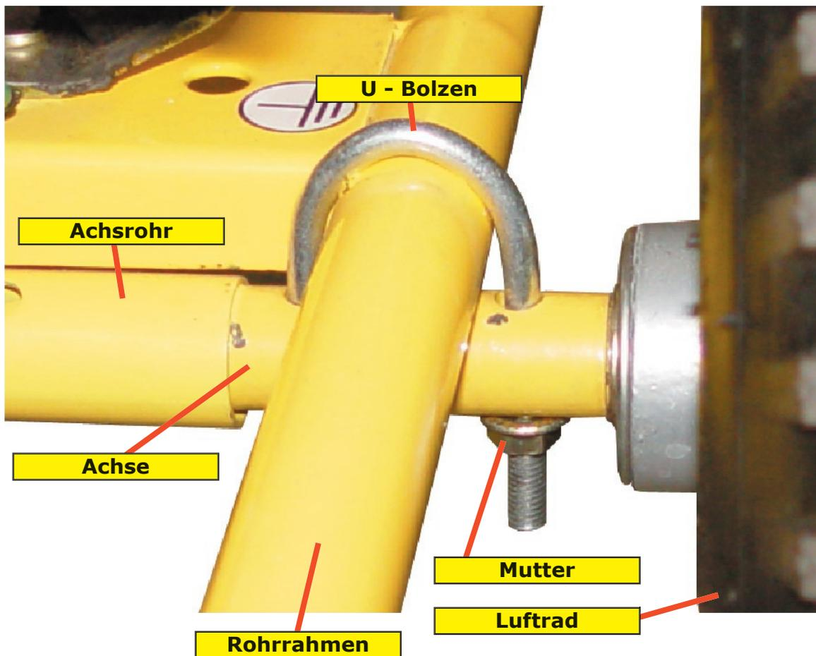
Stecken Sie nun die Räder auf die Achse. Drücken Sie die Klemmscheibe auf die Achse und montieren Sie den Sicherungssplint. Danach montieren Sie die Achskappen auf die Klemmscheiben. Montieren Sie nun die restlichen Teile wie Abgebildet.
