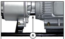
Einen defekten Wellendichtring erkennt man daran, dass an der Sicherheitsöffnung (A) zwischen Motor und Pumpenkörper Wasser austritt.
