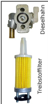
Klemmen Sie die Treibstoffleitung (Metallklammern zusammendrücken und verschieben, dann kann der Schlauch abgezogen werden) und die Rückleitung vom Tank ab.
