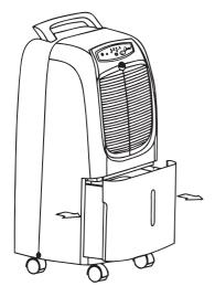
Sollte der Wassertank voll sein, leuchtet die Warnanzeige "WATER FULL" auf und das Gerät stoppt den Betrieb automatisch.
