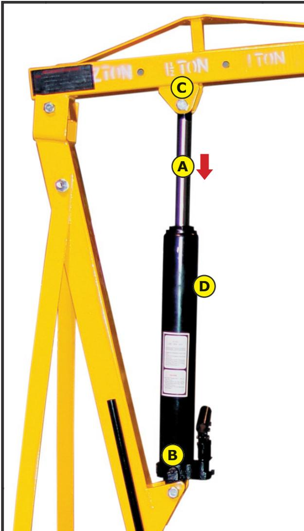
Bringen Sie den Hydraulikarm (A) durch öffnen der Absenkschraube (B) in die niedrigste Position (ganz eingefahren).
